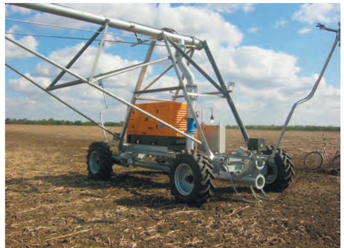
Рис. 3 – Загальний вигляд силового візка дощувальної машини (вигляд збоку зі сторони дощувальної ферми)
