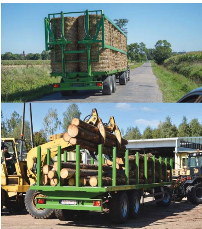
Рис. 6 – Універсальний причіп-платформа T028KM для транспортування рулонів і колод виробництва «Pronar»
