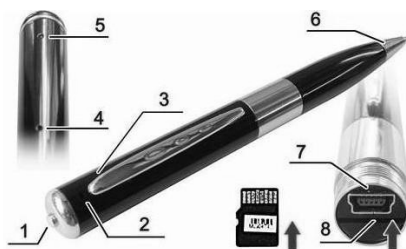
Рис. 9. Система прихованого відеозапису, вбудована в авторучку: 1 – кнопка «Вкл./викл.»; 2 – камера; 3 – мікрофон; 4 – кнопка «Скинути налаштування»; 5 – індикатор статусу; 6 – кулькова ручка; 7 – порт USB; 8 – картоприймач
