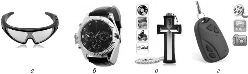
Рис. 6. Пристрої прихованого відеозапису, вмонтовані в аксесуари, прикраси тощо: а) сонячні окуляри; б) наручний годинник; в) прикраса; з) автобрелок
