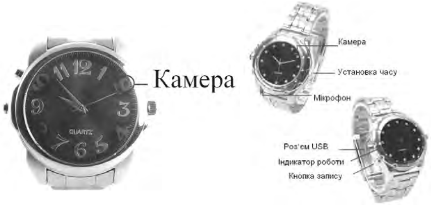
Рис. 11. Система прихованого відеозапису, вбудована в наручний годинник
