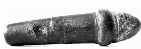
Рис. 1. Патрон .58 Burnside времен Гражданской войны в США (1861–1865) не был полностью унитарным, т. к. капсюль снаряжался в винтовку отдельно и воспламенял заряд пороха через небольшое отверстие в донной части конической гильзы
