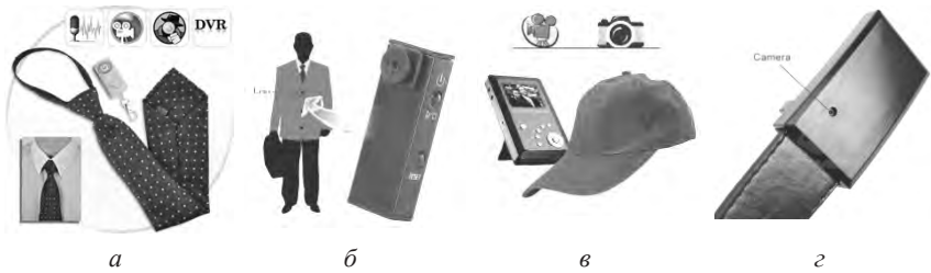
Рис. 5. Пристрої прихованого відеозапису, вмонтовані в предмети одягу: а) краватка (з пультом дистанційного керування); б) гудзик; в) кашкет; з) ремінь
