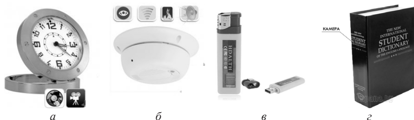
Рис. 7. Пристрої прихованого відеозапису, вмонтовані в побутові предмети: а) настільний годинник; б) детектор диму; в) запальничка; г) книга
