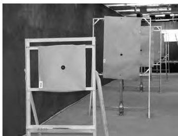
Рис. 5. Загальний вигляд обладнані для експериментальної стрільби балістичної трасі (планшети із мішенями встановлені на відстанях 5 («1»), 10 («2»), 15 («3»), 20 («4») і 25 («5») м від дульного зрізу зброї)
