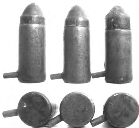
Рис. 3. Шпилечные патроны калибра 7 mm Lefauchaux с разной длиной гильзы: слева – патрон неизвестного производителя (длина гильзы 15,6 мм), в центре – патрон бельгийской фабрики Charles Fusnot (длина гильзы 15,0 мм), справа – патрон французской фабрики Gaupillat раннего выпуска (длина гильзы 14,0 мм)
