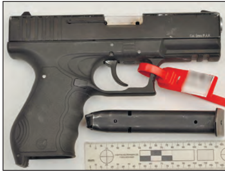
Рис. 1. Сигнальный пистолет, переделанный для стрельбы патронами калибра 9 мм Парабеллум
