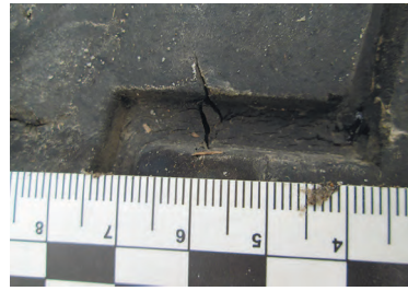
Рис. 6. Пошкодження зовнішнього герметизованого шару протекторної зони шини № 2
