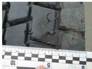
Рис. 3. Пошкодження зовнішнього герметизованого шару протекторної зони шини № 1
