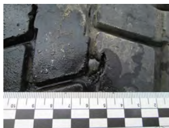
Рис. 11. Пошкодження зовнішнього герметизованого шару протекторної зони шини № 3
