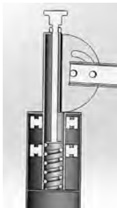
Рис. 5. Детальний вигляд регулятора руху на стійці
