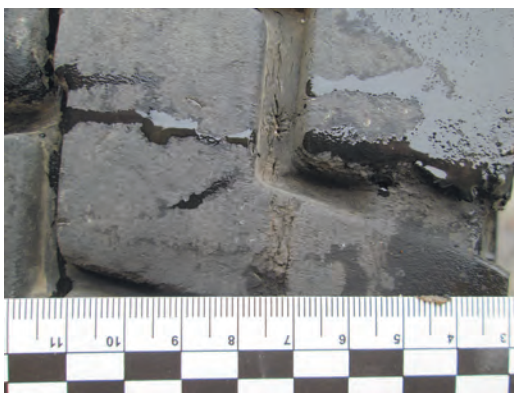
Рис. 4. Пошкодження зовнішнього герметизованого шару протекторної зони шини № 1
