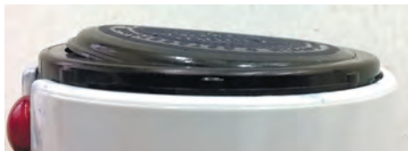
Рис. 22. Зміщення щодо центра оснастки кліше печатки, виготовленого за флеш-технологією, з вивільненням за межі кільця
