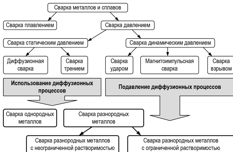
Рис. 1. Схема классификации сварочных процессов по применимости для получения неразъемных соединений металлов с ограниченной взаимной растворимостью по признаку применения диффузионных процессов
