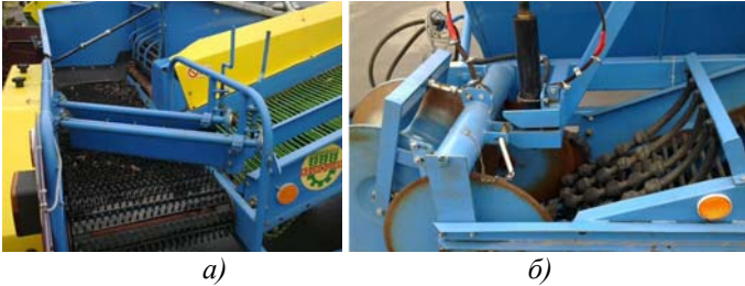
а – поперечний транспортер з напрямними вальцями; б – пристрій для розбивання грудок ґрунту
