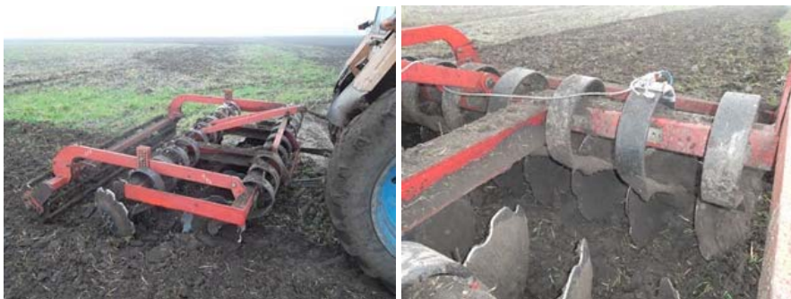
Рисунок 2 – Внешний вид агрегата с упругими стойками во время проведения экспериментов
