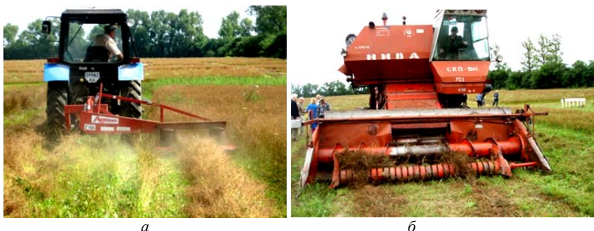
а – скошування у валки косаркою роторною навісною Z-169; б – підбирання валків зернозбиральним комбайном СК-5 М
