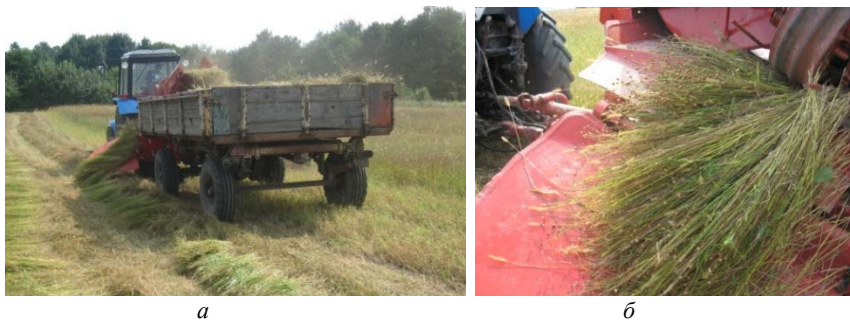
а – комбайн ЛК- 4А в роботі; б – необчисані насіннів коробочки на стеблах
