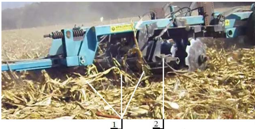
1 - стебла кукурудзи; 2 – лижний пристрій для попередньої деформації стебел рослин та формування їх щільного шару
