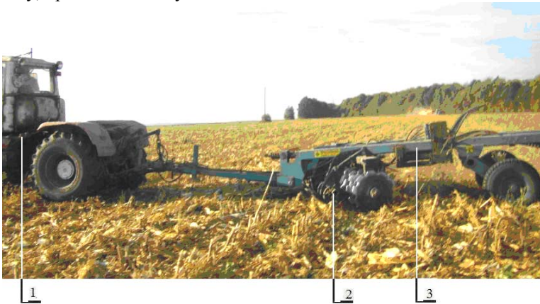
1 – трактор Т-150К; 2 – лижний пристрій для попередньої деформації стебел рослин та формування їх щільного шару; 3 – важка дискова борона БДВП-3,0
