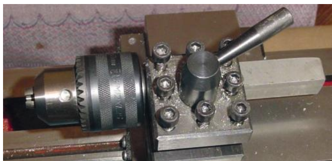
Рисуюнок 2 – Узел кріплення оправки для радіального навантаження підшипника
