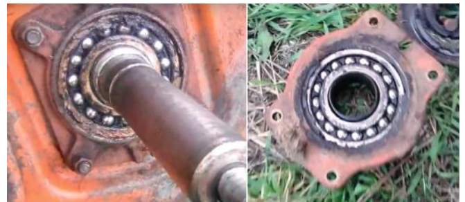
Рисунок 1 – Спрацьованість підшипникових вузлів молотильного барабана зернозбирального комбайна
