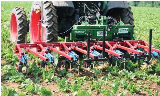
Рисунок 1 – Фотографії мотики Kult-robocrop® з автоматичною системою рульового керування на базі камери в роботі в рядках цукрових буряків у фазі 8-листіків [6]
