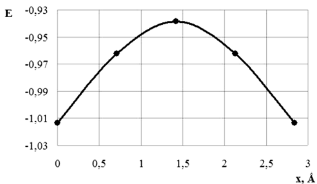
Рис. 3. Потенціальний рельєф зміщення молекули води уздовж поверхні графену в напрямку [1100]; відстань молекули води від графену дорівнює 2,9 Å. Енергія подається в атомних одиницях на один атом, відстань – у Å
