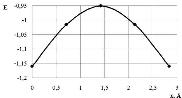
Рис. 2. Потенціальний рельєф зміщення молекули води уздовж поверхні графену в напрямку [1100]; відстань молекули води від графену дорівнює 1,9 Å. Енергія подається в атомних одиницях на один атом, відстань – у Å
