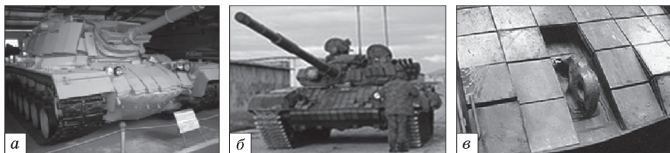
Рис. 33. Елементи динамічного захисту на ізраїльському танку М48А3 (Магах-3) (а), танку Т-72 (б) і польському танку ПТ-91 («Твердий») (в) [119]
