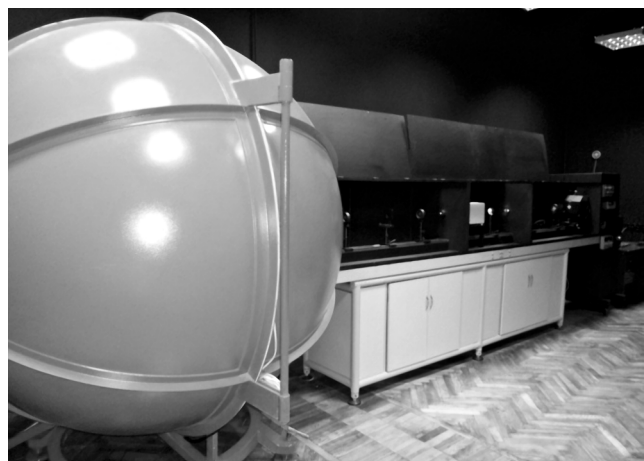
Рис. 1. Фотография государственного первичного эталона единицы светового потока — люмена
