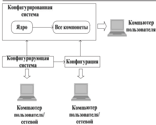
Рис.2. Принципиальная схема реализации первого подхода к разработке конфигуратора
