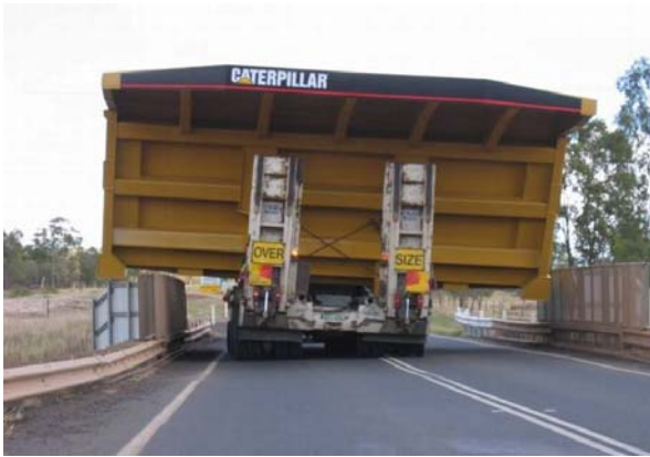
Рис. 5. Дорожные условия и вписывание в габариты городских коммуникаций при перевозке большегрузного автосамосвала и его комплектующих
