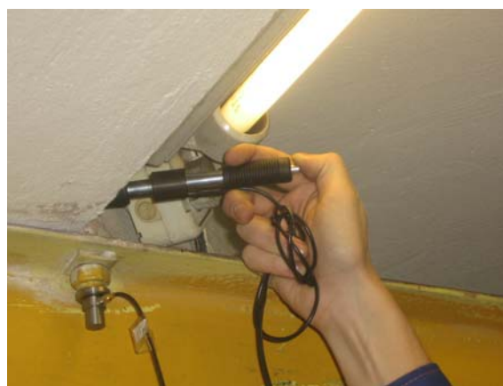
Рис. 2. Процедура создания вибропортрета элементов металлоконструкций.
