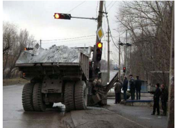
Рис.8. Дорожные условия, приведшие к возникновению аварийной ситуации при выходе большегрузного автосамосвала на городские транспортные коммуникации
