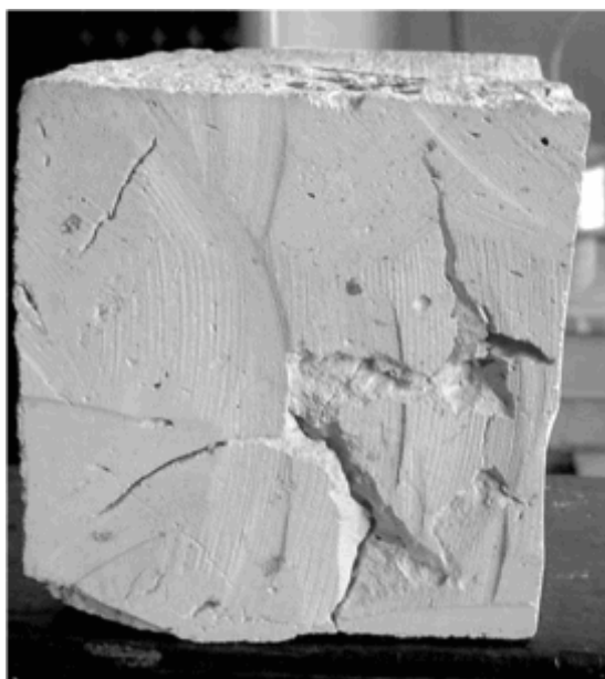
Рис. 5. Дефекти внутрішньої структури старовинної цегли
