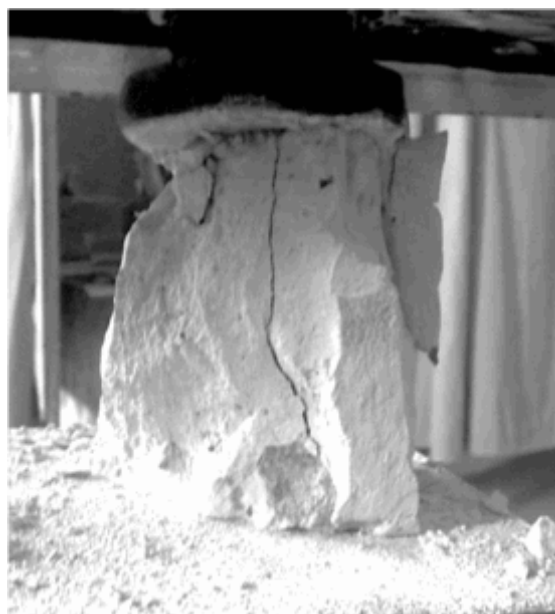
Рис. 6. Механічне випробування цегляних зразків
