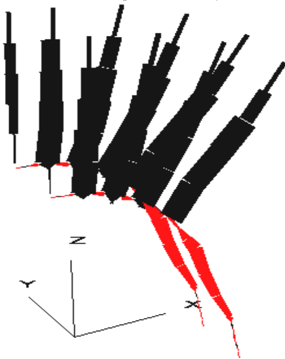
Рис. 8. Спільний розподіл нормальних згинальних моментів і зусиль натягу в анкерах на кінцевій стадії моделювання
