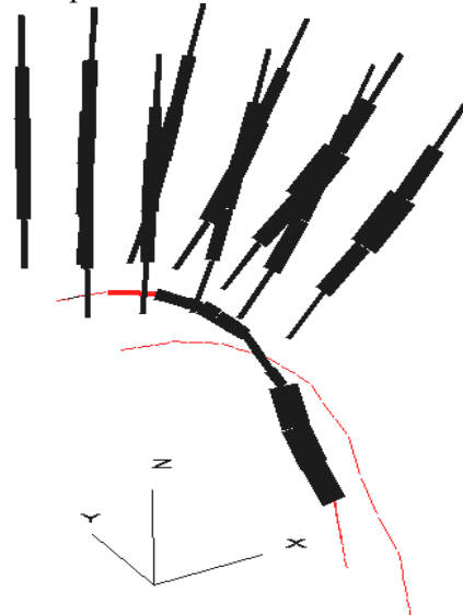
Рис. 3. Розподіл натягу в анкерах і скручуючі моменти в рамі на кінцевому етапі моделювання
