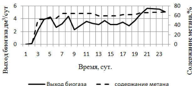
Рис. 4. Процесс образования биогаза и содержание метана при 40 °C
