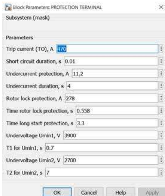
Рис. 4. Приклад введених параметрів блоку «Protection terminal»
