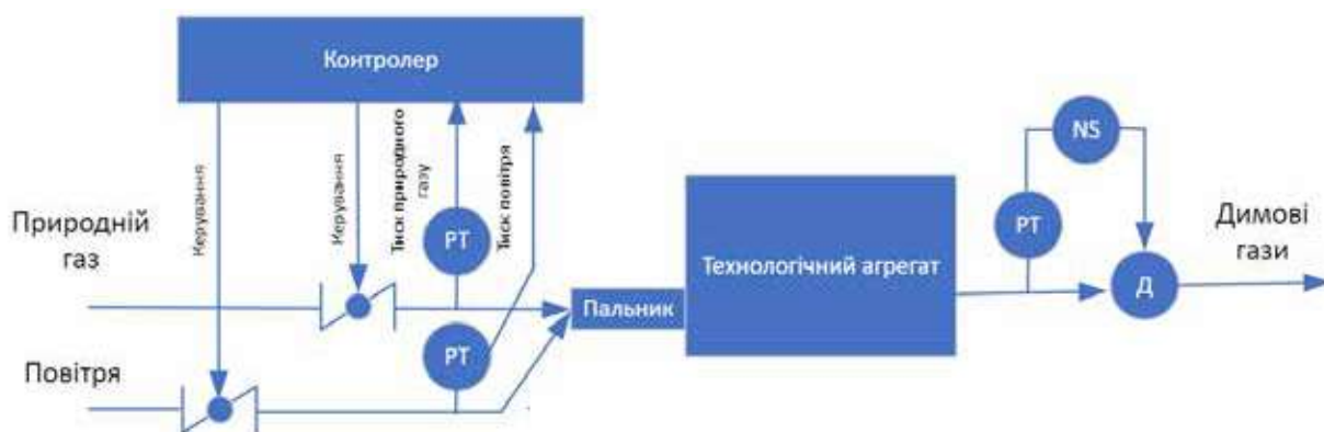
Рис. 4. Схема використання датчиків тиску природного газу та повітря
