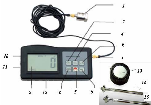
Рис.2. Виброметр VM6360: 1 – акселерометр; 2 – дисплей; 3 – входной разъем; 4 – кнопка функций удержания максимальных значений; 5 – кнопка питания; 6 – кнопка преобразования системы единиц измерения; 7 – кнопка функции; 8 – кнопка фильтра; 9 – кнопка звука; 10 – разъем для наушников; 11 – разъем RS232C; 12 – крышка батарейного отсека; 13 – магнитный датчик; 14 – шаровой зондовый датчик; 15 – конусный зондовый датчик
