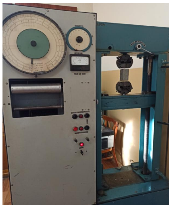
Рис. 1. Випробування фібри на витягування з бетонних призм.
