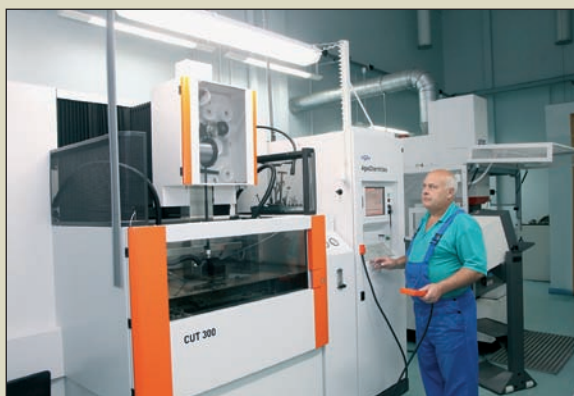
Вирізний верстат електроскрової обробки фірми “Ажі Шарміль” (GF Agie Charmilles) дротом, тоншим за людську волосину, здатний вирізати філігранні фігури в металі завтовшки до 250 мм. Можливості цього верстата широко використовуються під час виготовлення карбувальних кілець у монетному виробництві та штампів для вирубування заготовок орденів і медалей.
