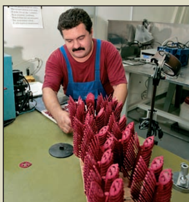
У цеху виготовлення орденів та медалей застосовується технологія художнього лиття. Моделі деталей нагород спочатку виливаються з воску або створюються на 3D-принтері, а потім втілюються в металі.
