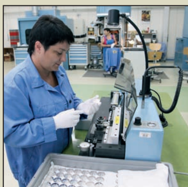
На цьому пристрої карбується напис на гурт монет із дорогоцінних металів – зазвичай вказується метал, його проба, маса дорогоцінного металу в чистоті, а також розміщується логотип Монетного двору.
