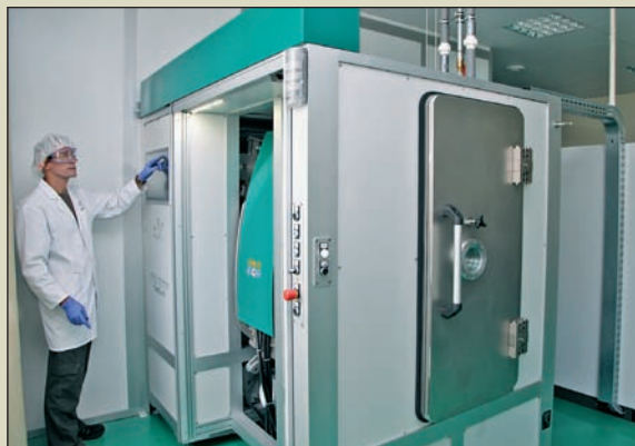
За участі іноземних фахівців завершується налагодження апарата з технологією “Пі Ві Ді” (PVD) – вакуумного наплення хромового покриття на друкарські форми інтагліодруку. Нова технологія прийшла на зміну традиційному гальванічному способу, є екологічно безпечною, дає змогу на 30–40% підвищити тиражостійкість друкарських форм, їхнє фарбосприйняття та скорочує час ручного полірування форм для відновлення їхньої поверхні.
