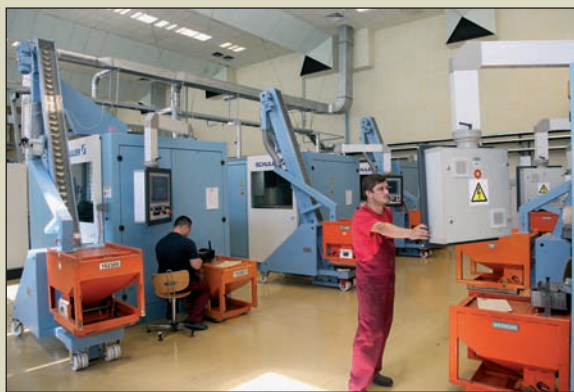
У цеху карбування розмінних та обігових монет оновлено парк обладнання: встановлено 10 нових високошвидкісних сучасних карбувальних прес-автоматів “Гребнер” (Grabener) вертикального карбування і 6 – “Шулер” (Schuler) горизонтального карбування. Преси створюють тиск 150 тонн, швидкість карбування залежить від діаметра заготовок і в середньому становить 550 штук за хвилину.
