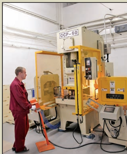
Вирубний прес із силою натискання 60 тонн, на якому виготовляють заготовки для пам'ятних монет із недорогих металів і сплавів. Новий верстат виготовляє заготовки з нейзильберу діаметром 31.0 мм і 35.0 мм, завдяки чому вдалося відмовитися від закупівлі відповідних заготовок за кордоном.
