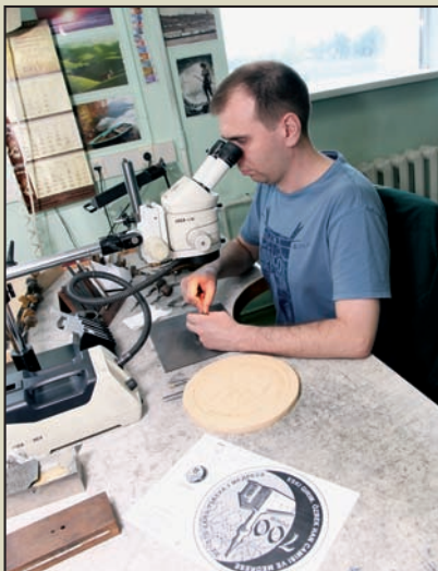
Зображення на пам'ятній монеті повинно точно відповідати ескізу та гіпсовій моделі. Завдання гравера — довести до бездоганого вигляду редуційний пуансон, з якого виготовлятиметься карбувальний інструмент.
