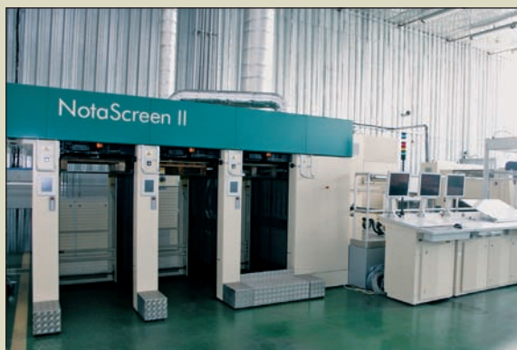
Двофарбова ротаційна машина трафаретного друку “Нота Скрін ІІ” (Nota Screen II) з магнітним модулем дає змогу відтворювати на банкнотах оптично змінні елементи за технологією “Спарк” (Spark). Це елемент захисту останнього покоління, його використання значно підвищує захищеність банкнот. Графічний елемент за цією технологією нанесено на пам'ятні банкноти номіналом 50 гривень, які тисячним тиражем були надруковані у 2011 році з нагоди 20-річчя Національного банку України.
