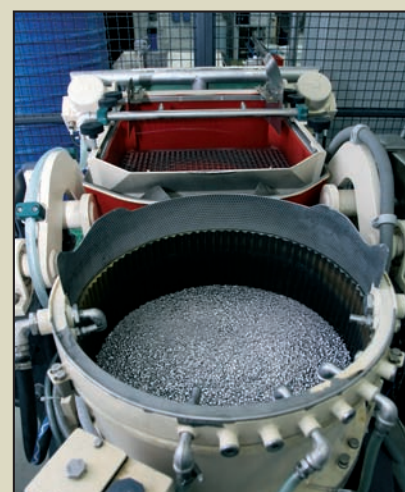
Установка фірми "Рослер" (Rösler) для полірування заготовок пам'ятних монет із дорогоцінних і недорогих металів. Заготовки завантажують у спеціальний барабан, наповнений кульками з нержавіючої сталі та спеціальними розчинами, і полірують упродовж 15–20 хвилин.
