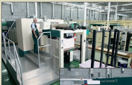
П’ятифарбова аркушева машина орловського інтагліодруку “Супер Орлов інтагліо III” (Super Orlof Intaglio III), яка наносить на банкноти графічні елементи, що виступають над поверхню паперу і відчутні на дотик. Новим друкарським машинам притаманні висока автоматизація та надійний контроль якості.
