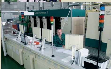
Введені в експлуатацію дві нові машини високого друку “Супер нумерота III” (Super Numerota III) і “Супер чек нумерота III” (Super Check Numerota III). Обладнання нумерує банкноти за допомогою нумераторів прямого приводу нового покоління NBX. Одночасно з нумеруванням ці машини здатні друкувати спеціальною фарбою додатковий захисний елемент, видимий в ультрафіолетовому промінні. Крім того, машина “Супер чек нумерота III” за допомогою системи AFX здійснює одночасний контроль якості й окремих захисних характеристик банкнот на друкарських аркушах.
