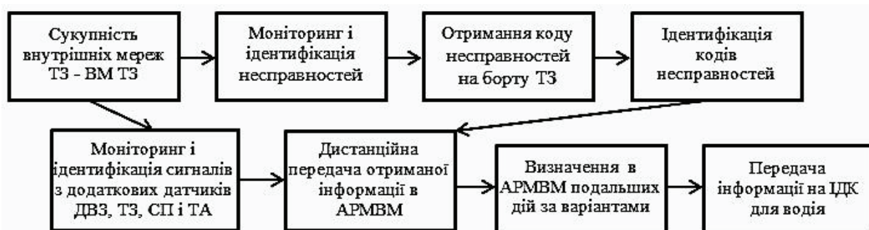
Рис. 4. Блок-схема моніторингу і визначення статусу несправностей на борту ТЗ з використанням ІДК
