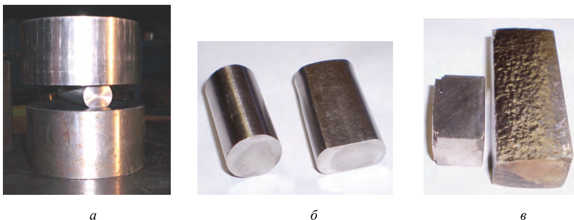
Рисунок 2 – Схема поперечного стиску (а) та отримані експериментальні зразки зі сталі 12Х15Г9НД (б) і сталі 110Г13Л (в). Зліва на позиціях б і в подані зразки у початковому незміщеному стані
