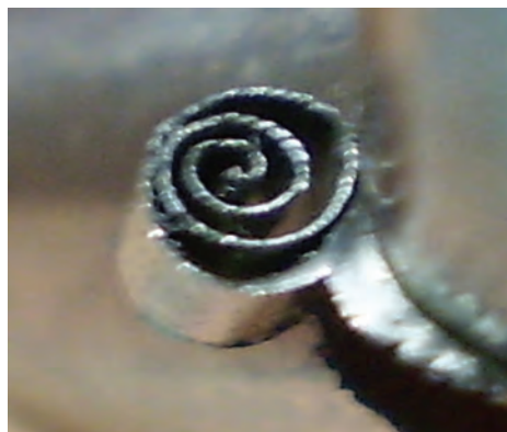
Рисунок 4 – Фрагменти стружкоутворення при вільному ортогональному різанні сталі 12Х15Г9НД (AISI 201), зміцненої по схемі поперечного стиску з деформацією 44,3%, у середовищі ріпакової оливи (а) та сульфозфрезолу Р (б). х 5
