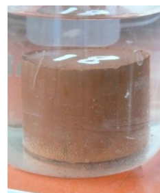
Рис. 2. Визначення коефіцієнту розм'якшення зміцненого ґрунту: а – зразок в нормальних умовах, б – зразок в умовах водонасичення
