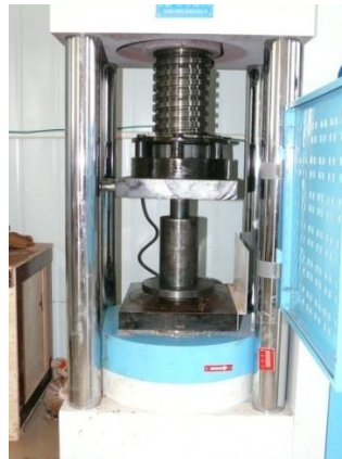
Рис. 1. Формування зразків для проведення випробувань методом напівсухого пресування.
