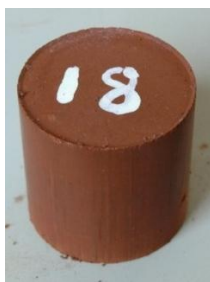
Рис. 2. Визначення коефіцієнту розм'якшення зміцненого ґрунту: а – зразок в нормальних умовах, б – зразок в умовах водонасичення
