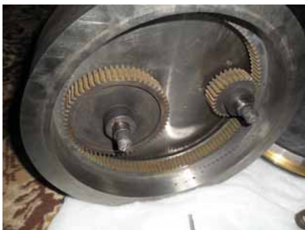
Рисунок 2. Планетарный механизм со снятой передней крышкой
