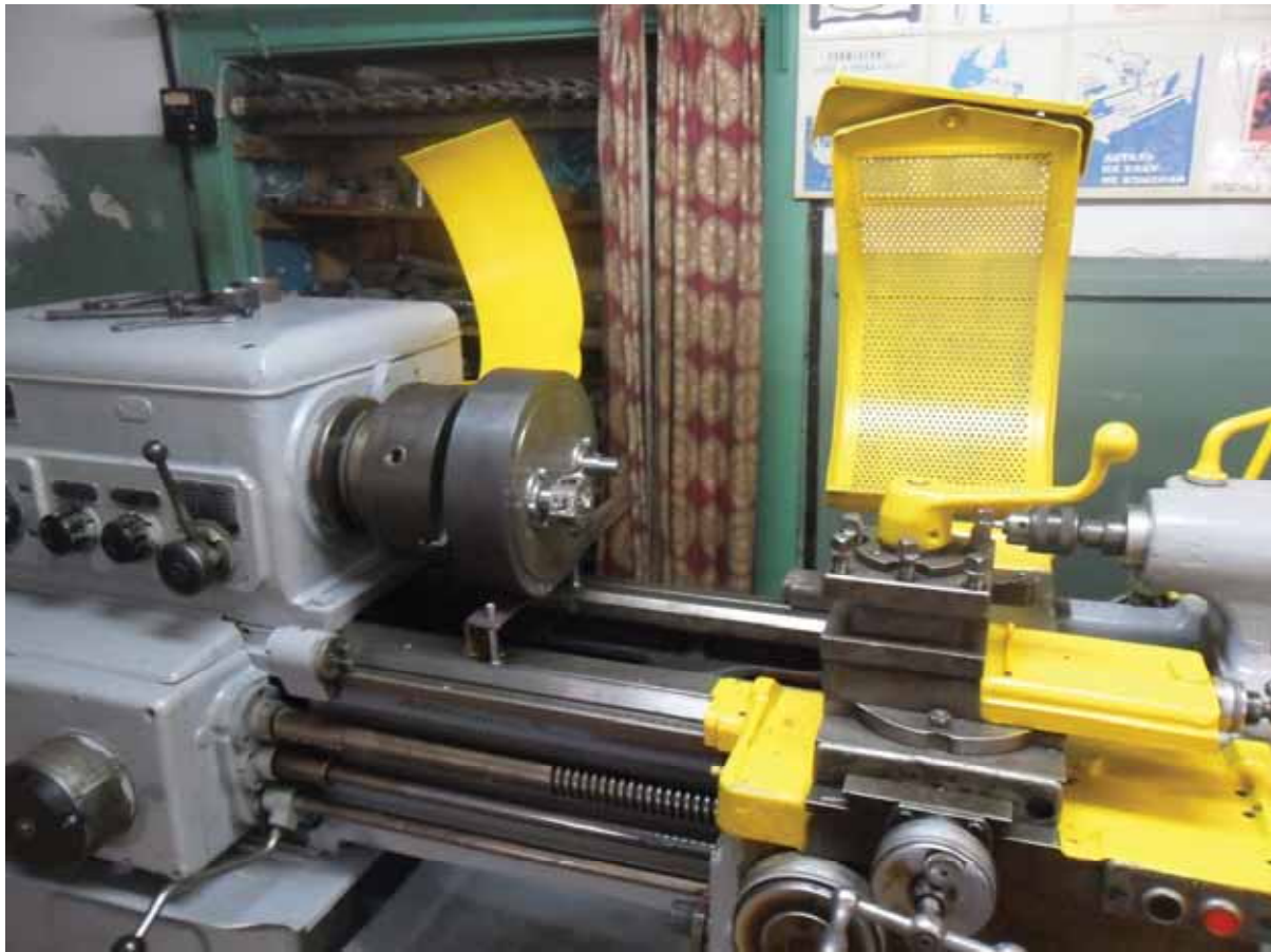
Рисунок 4. Планетарний механізм, установлений на станок 16K20
