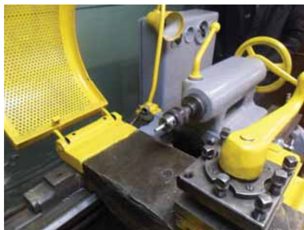
Рисунок 3. Закрепление опытного образца в задней бабке станка 16К20
