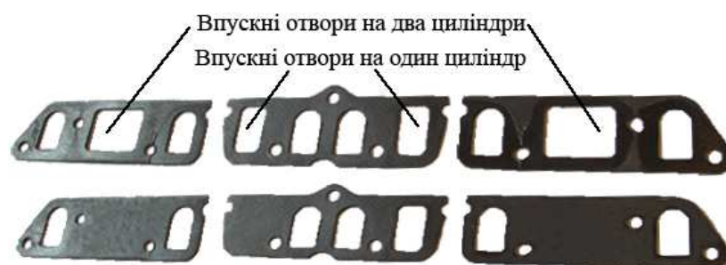
Рисунок 1 – Прокладки газопроводів двигуна ГАЗ-51 Штатні (зверху); використовувані в експерименті (знизу) – один працюючий циліндр
