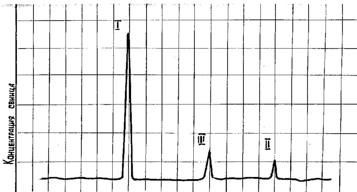
Рис. 1. Содержание свинца в поверхностном слое образцов. I-исходный образец; II - образец, контактировавший с водой в динамических условиях при экспозиции 14 месяцев; III - образец, контактировавший в статических условиях при экспозиции 2,5 года.
