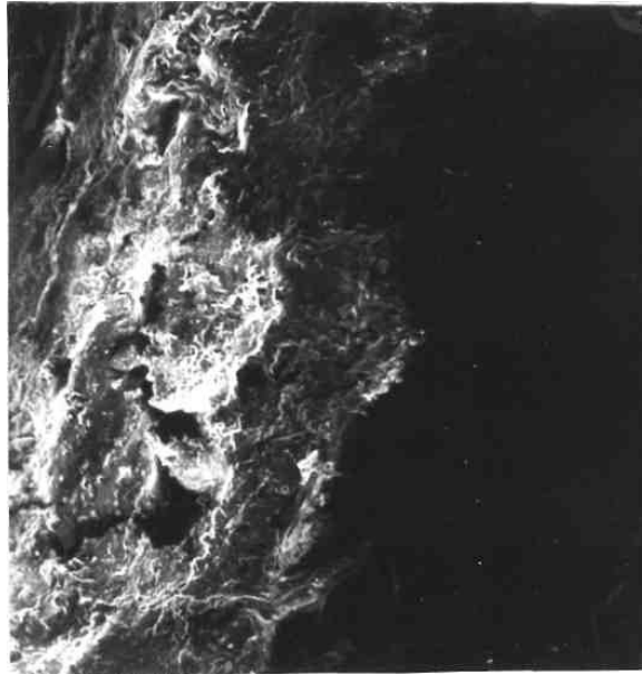
Рис. 4. Микрофотография поперечного скола ПВХ-образца трубы (экспозиция 26 месяцев).
