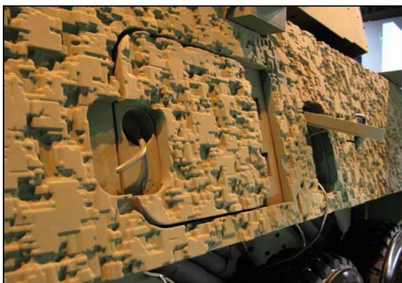
Рис. 7. Інноваційний накладний 3D камуфляж TactiCam (покривання може застосовуватися з іншими матеріалами, поглинаючими/знижуючими інфрачервоний або радіолокаційний випромінювання, а також може заповнюватися ізоляційним матеріалом, який зменшує власне теплове випромінювання і нагрів від надлишкового сонячного тепла)
