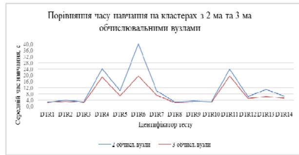
Рис. 4. Порівняльний аналіз часу навчання на гомогенних кластерах з 2 та 3 обчислювальними вузлами (workers)
