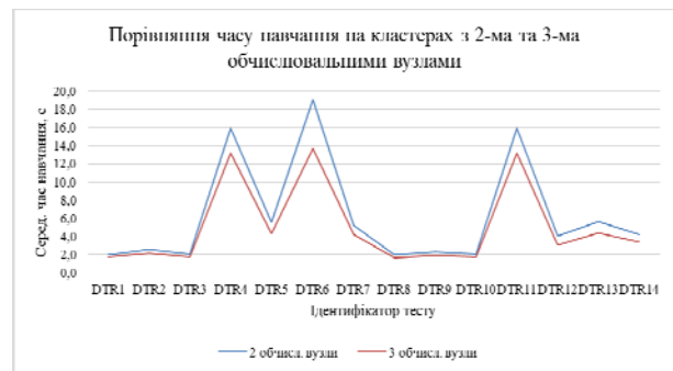
Рис. 5. Порівняльний аналіз часу навчання на гетерогенних кластерах з 2 та 3 обчислювальними вузлами (workers)
