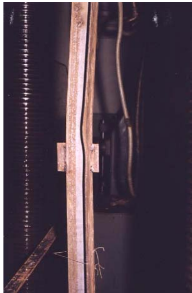
Рис. 3. Втрата місцевої стійкості полочки кутика в місці приварювання з'єднувальної пластини
