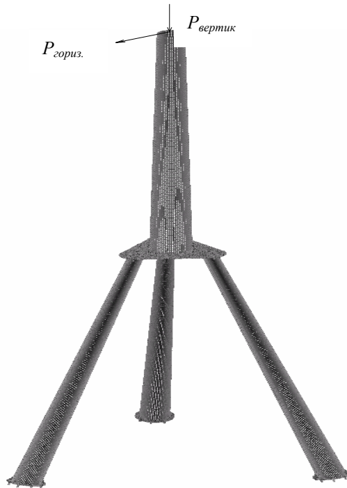
Рис. 1. Конструктивна схема складної треножної опори (кінечно-елементна модель)
