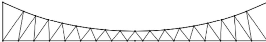
Рис. 7. Геометрия подвесок всячего моста
