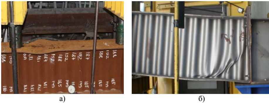
Рис. 1. Експериментальні дослідження на кафедрі металевих та дерев'яних конструкцій КНУБА: а – місцева втрата стійкості стиснутої полиці; б – загальна втрата стійкості синусоїдно гофрованої стінки при зсуві
