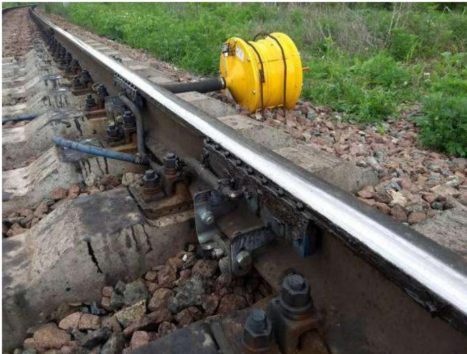
Рис. 3 – Рейкозмашувач «Rail Lubricurve 50» виробництва компанії «Whitmore Manufacturing Co»
