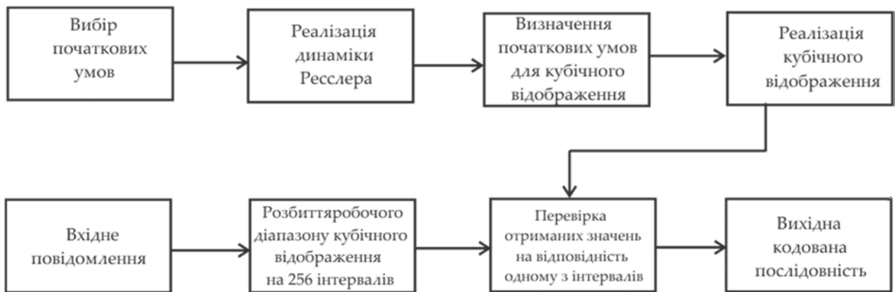
Рис. 5. Структурна схема алгоритму шифрування
