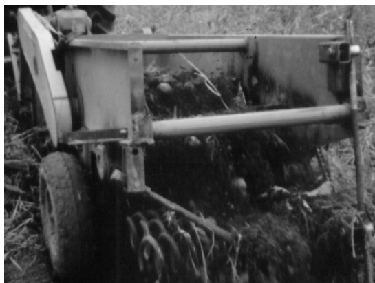
Рисунок 5 – Загальний вигляд вдосконаленого очисника картопляного вороху під час проведення експериментального дослідження
