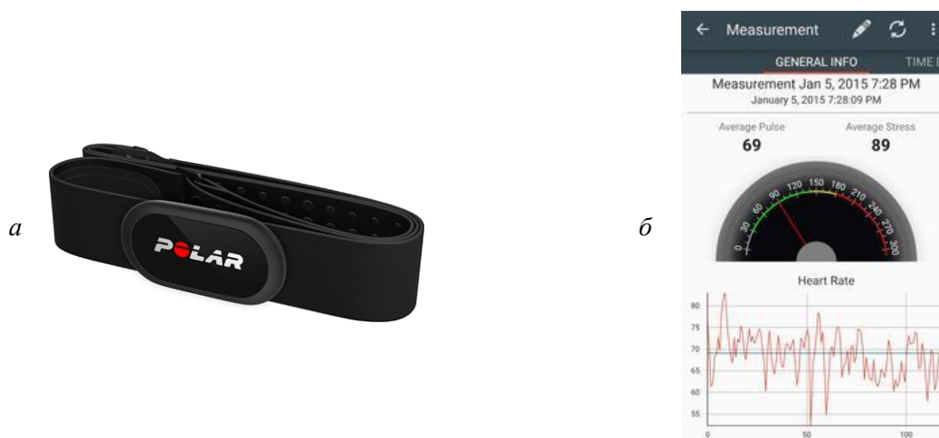
Рис. 1. Прилад (а) та програмне забезпечення (б), що було використано для проведення досліджень ФС водіїв
