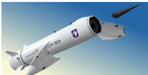
Рис. 7. Зовнішній вигляд: а) - гіперзвукової аеробалістичної ракети AGM-183A ARRW (масо-габаритний макет) та б) - планеруючого блоку TBG при відокремленні від ракети
