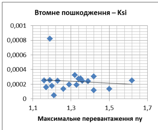
Рис. 8. Залежність втомнісного пошкодження силових елементів крила літака Іл-76 від максимального вертикального перевантаження літака. Джерело: розроблено авторами.
