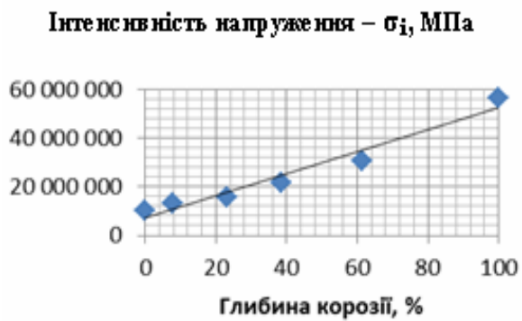
Рис. 6. Залежність інтенсивності напружень \sigma_i від глибини корозійного ураження у відсотках.
