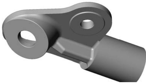
Рис. 5. Математична модель вузла кріплення редуктора вертольота Ми-8.
