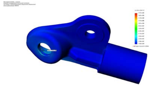
Рис. 10. Напруження вузла кріплення редуктора вертольота Ми-8 з корозійними ураженнями.
