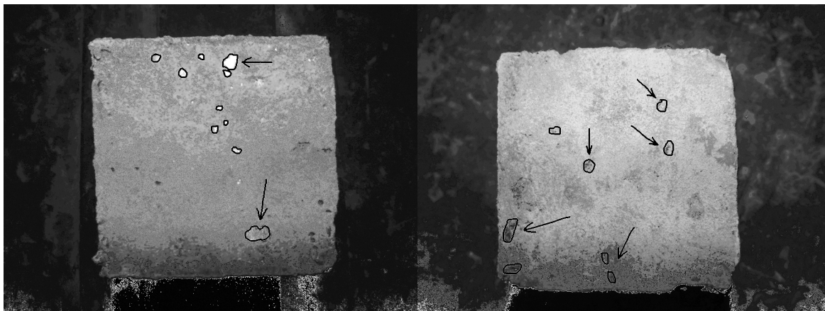
Рисунок 3 – Поверхня сталі (зліва) та бетону після руйнування
