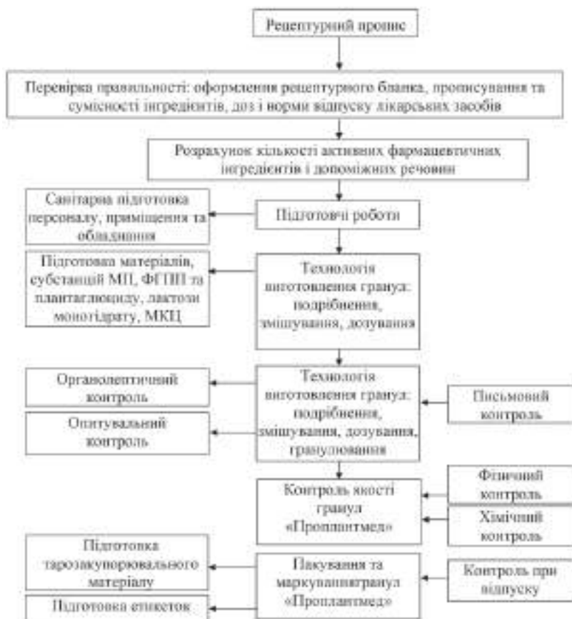
Рис. 1. Блок-схема технологічного процесу виготовлення гранул «Проплантмед» в умовах аптечного виробництва
