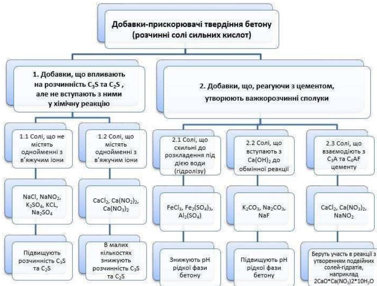
Рис. 1. Класифікація В. Б. Ратінова добавок солей-електролітів – прискорювачів твердіння
