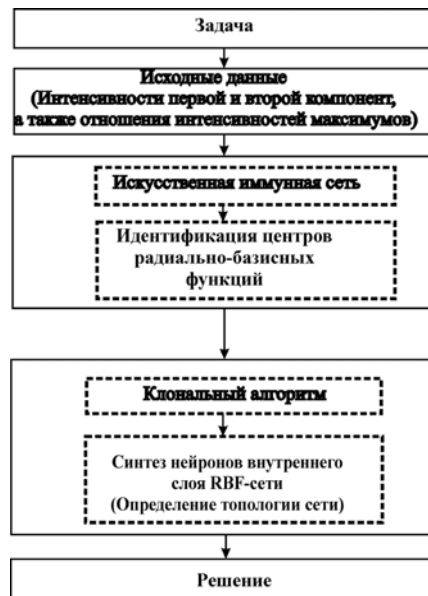
Рис. 3 Обобщенная схема синтеза и обучения радиально-базисной нейронной сети с помощью алгоритма клонального отбора и алгоритма искусственной иммунной сети
