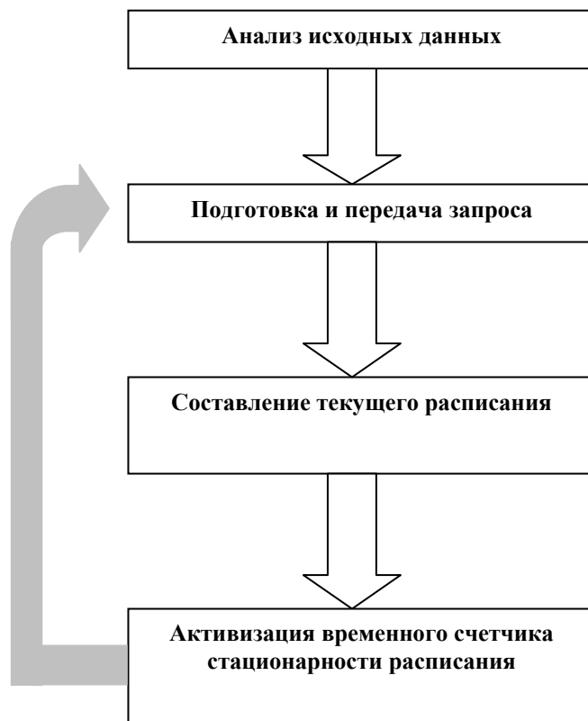
Рис.1 Схема работы подсистемы «Расписание»
