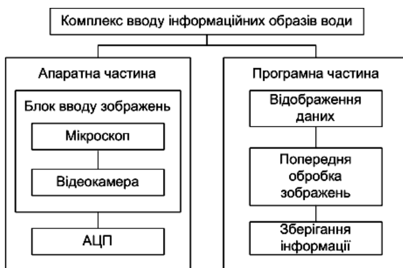
Рис. 6 Структура програмних і апаратних засобів комплексу вводу інформаційних образів води
