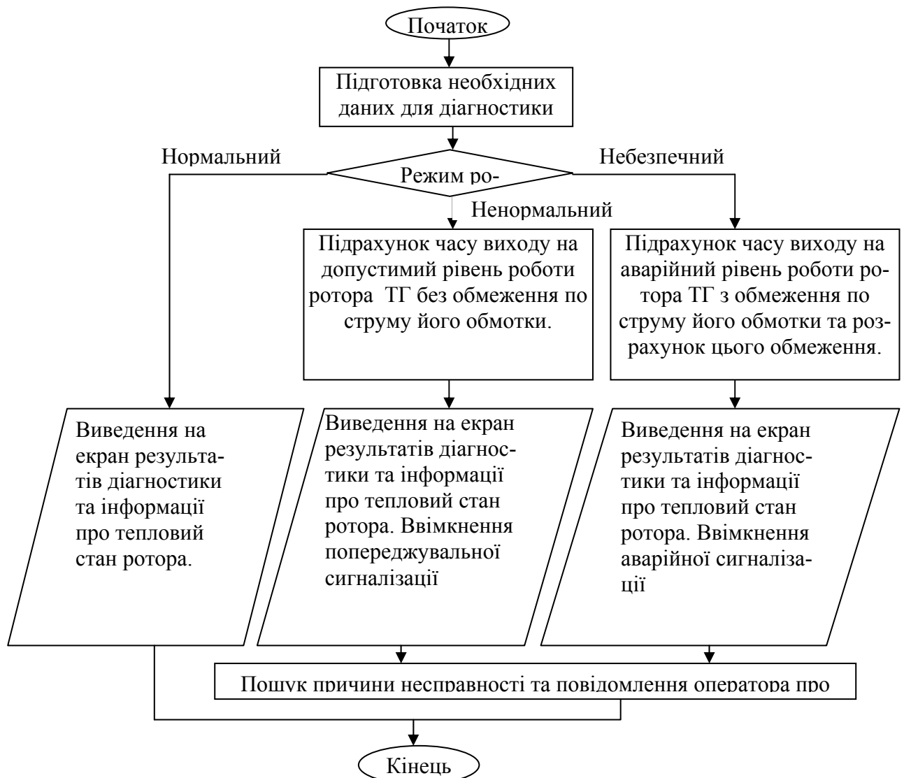
Рис. 1 Спрощена блок-схема алгоритму діагностики теплового стану ротора ТГ
