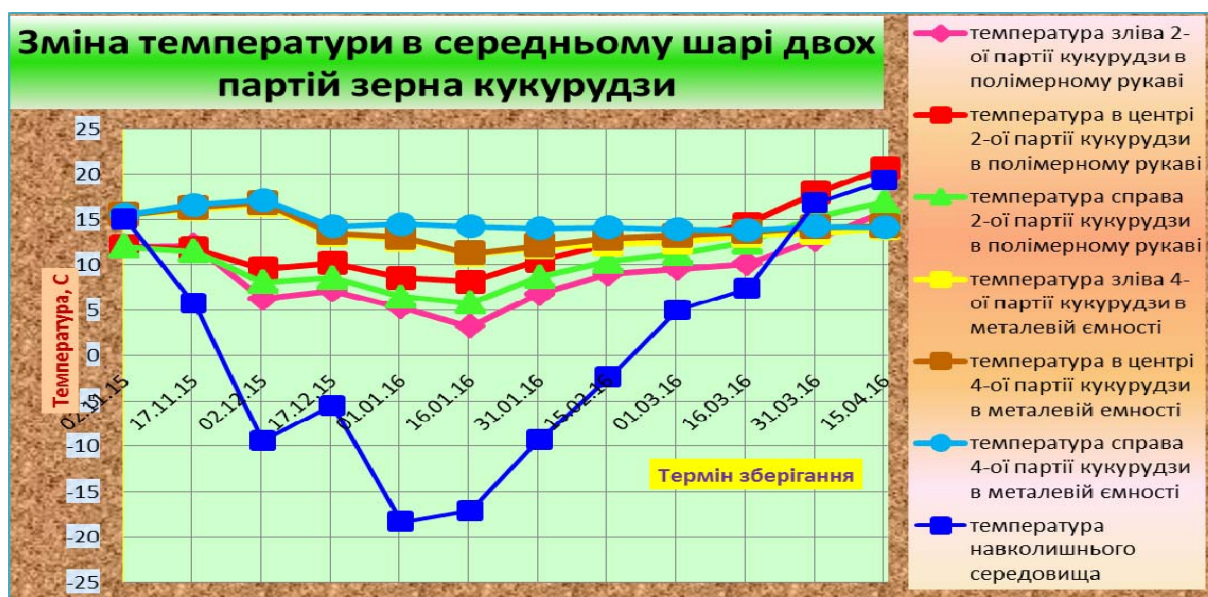
Рис. 2. Зміна температури в різних частинах середнього шару II та IV партії зерна кукурудзи, що зберігалася в ПРЗ та металевих ємностях
